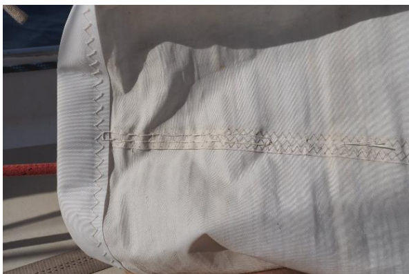
Die reparierte Naht der Genua
